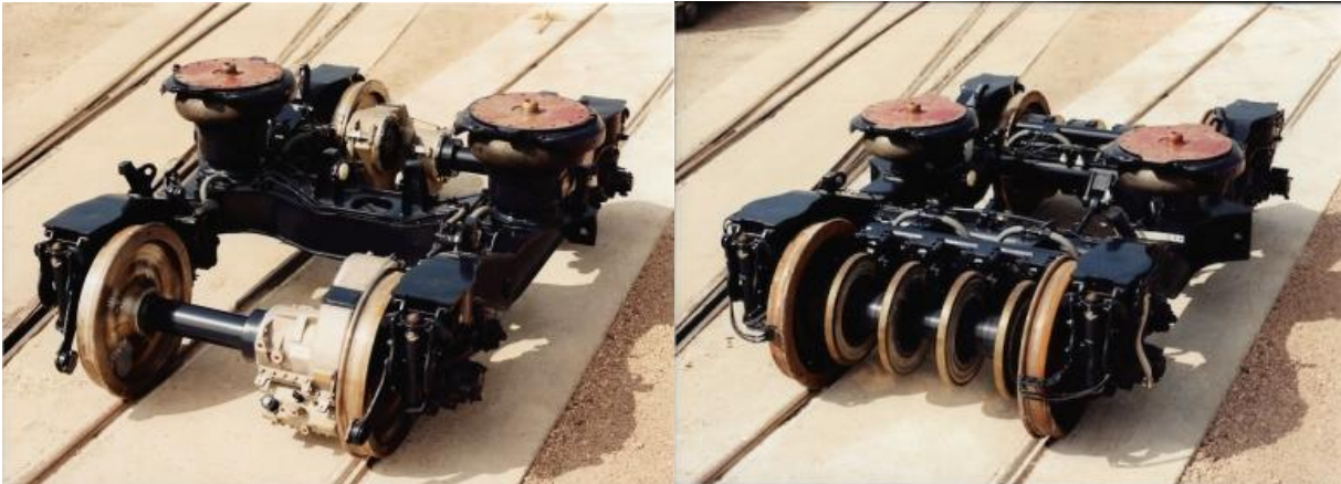
Figure 79 – Bogie moteur (à gauche) et bogie porteur (à droite). Le bogie moteur n’est équipé que du pont moteur. Le moteur, le réducteur et la tripode viennent se loger dans l’espace entre l’essieu et le châssis du bogie.
