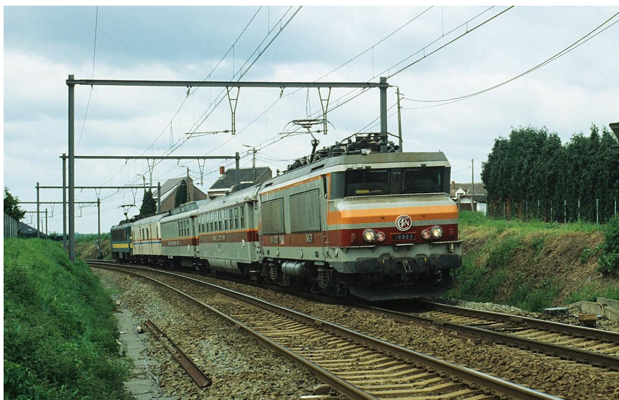
Figure 17 – Seconde version de la BB 10003 à Enghien. La HLE 2760 en queue assure un effort de retenue. Trois voitures de mesure sont incorporées au convoi.
