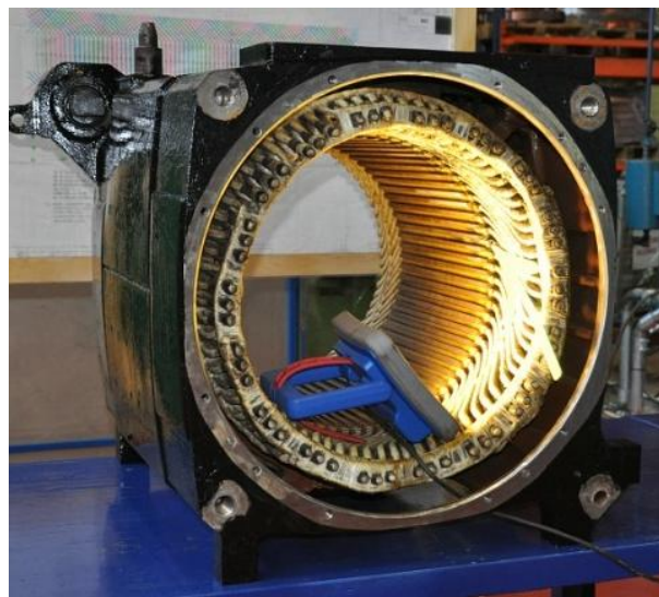
Figure 58 – Moteur complet, stator bobiné et rotor à cage d'écureuil. Ces moteurs sont réhabilités aux ateliers SNCB de Salzinnes.
