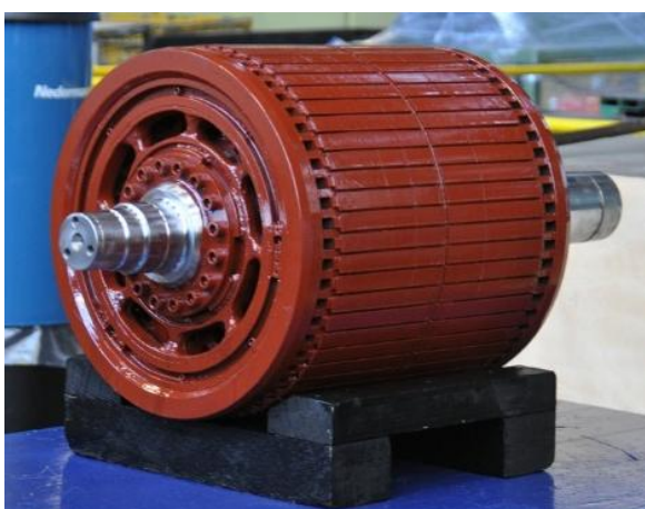
Figure 58 – Moteur complet, stator bobiné et rotor à cage d'écureuil. Ces moteurs sont réhabilités aux ateliers SNCB de Salzinnes.
