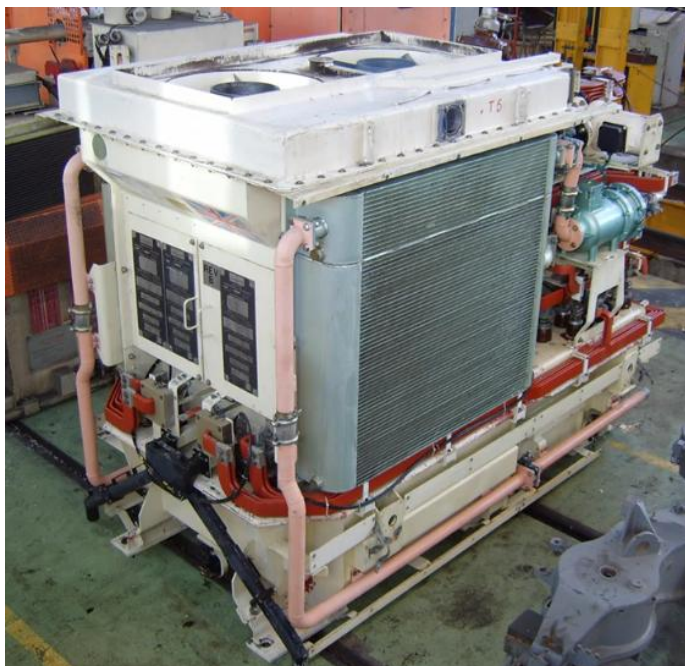
Figure 33 (à gauche) – Transformateur principal. On peut distinguer les deux radiateurs et le groupe motoventilateur sur le dessus.
