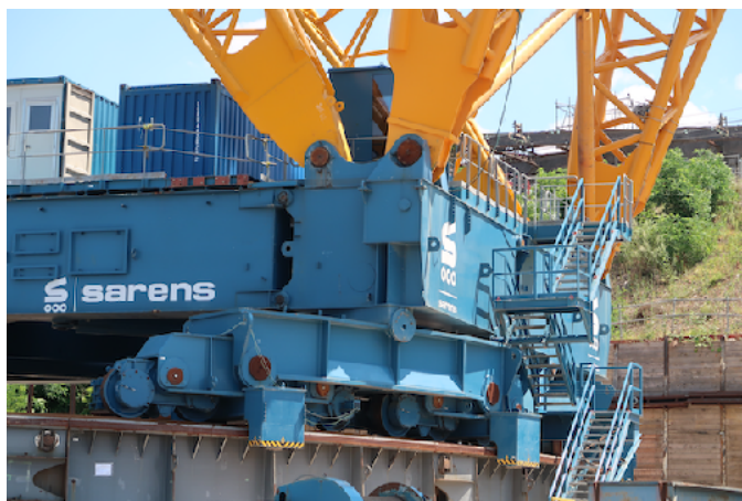
Figure 12 : rail circulaire sur un châssis métallique soutenu par une dalle en béton.
