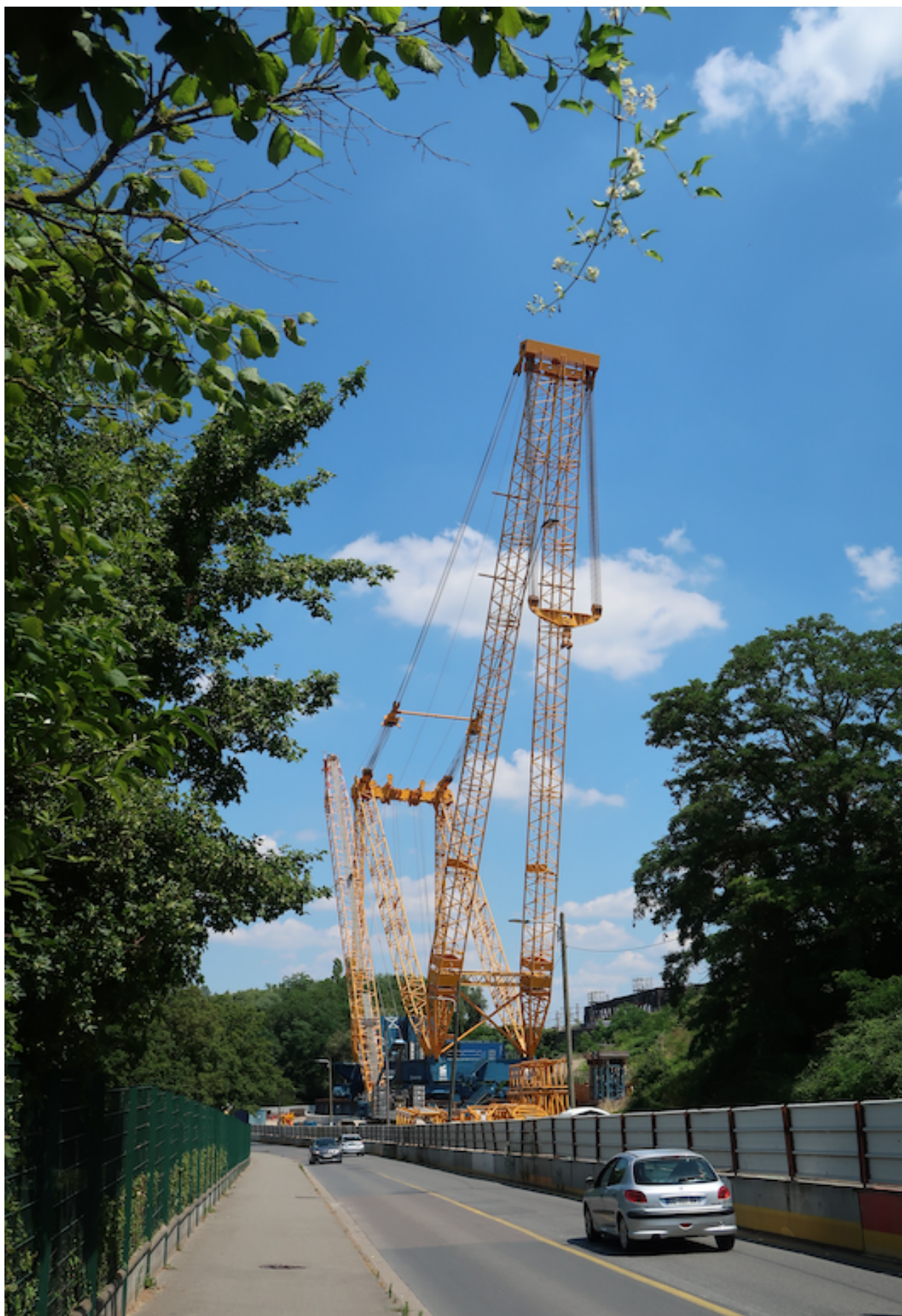
figure 16 : 100 m de haut, 4544 tonnes, une base circulaire de 35 m de diamètre, 2700 tonnes de lest, une capacité de levage de 1600 tonnes: des dimensions hors normes ! Cliché Alain Jeunesse juillet 2023.
