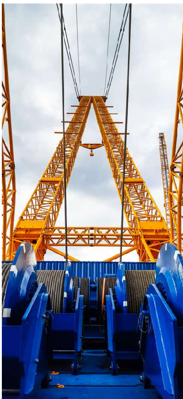
figure 20 : entre les « pattes » de Little Celeste, les treuils électriques. (Cliché SARENS référence 5)
