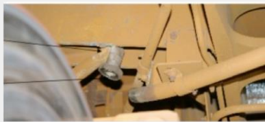
Détail de la rupture CG en remorque d'extrémité R8.
