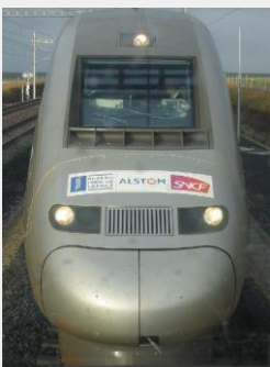
Figure 10 : Pose du vitrage affleurant. A comparer avec le vitrage et le revers d'eau des motrices duplex
