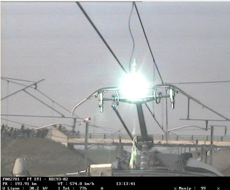
Figure 47 : Le couple pantographe-caténaire : 574,8 km/h PK 193, 91. Tension : 30,2 kV. Intensité captée sur une génératrice de longueur 60 mm : 776 Aeff
