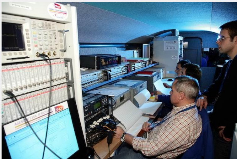
Figure 31 : : « Labo du haut » : partie consacrée à la dynamique ferroviaire, surveillance de l'interaction véhicule-voie.
