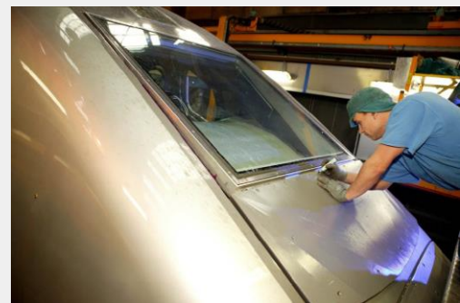
Figure 10 : Pose du vitrage affleurant. A comparer avec le vitrage et le revers d'eau des motrices duplex
