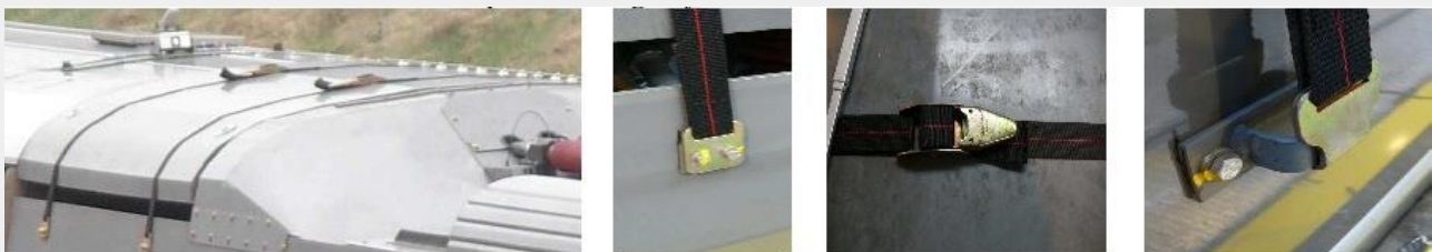
Figure 22 : Photographies illustrant la mise en place de sangles de maintien autour du capot 7 de la motrice de queue (M1).
