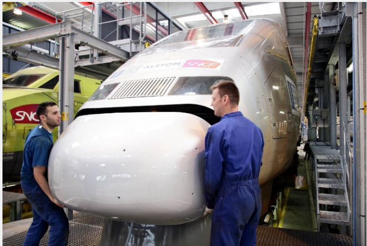
Figure 24 : Pose de la trappe monobloc sur la motrice de tête M2 par les agents de maintenance dédiés à la rame V150.
