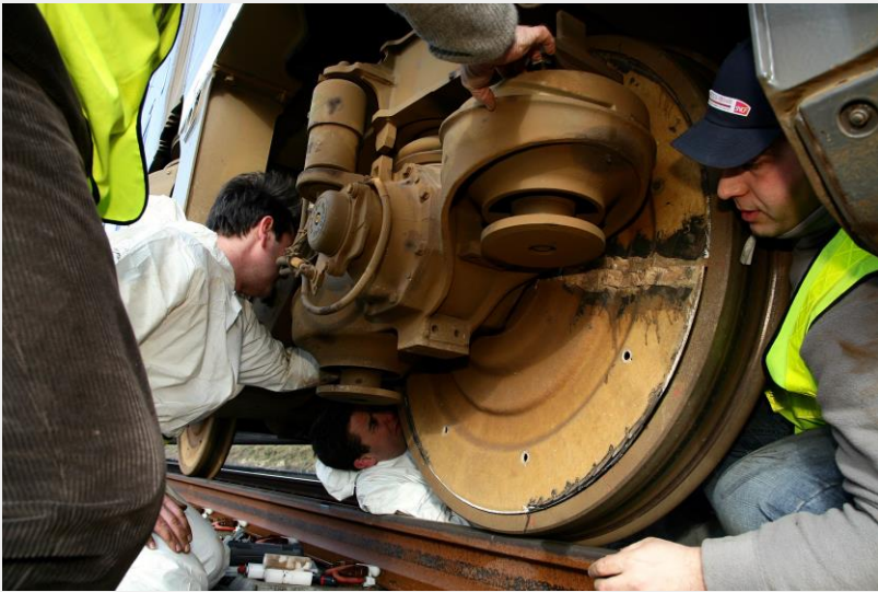
Figure 39 : Flasque disposé sur une roue instrumentée pour protéger les capteurs. Et morceau de flasque détruit. La dénomination technique étant devenue : « frisbees » ...
