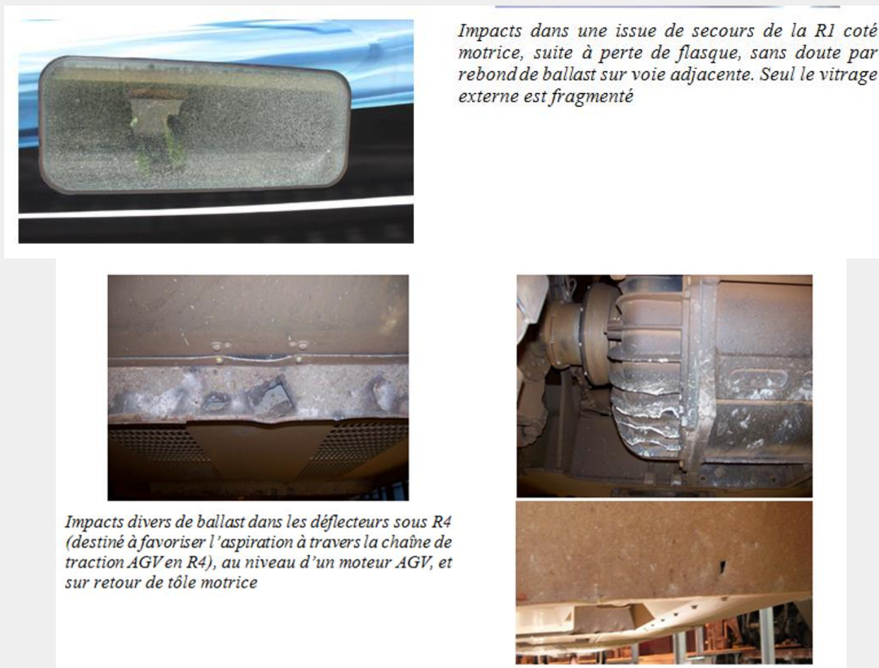
Figure 37 : conséquences de la perte d'un flasque de protection des roues instrumentées : vitre brisée, chocs sous caisse.
