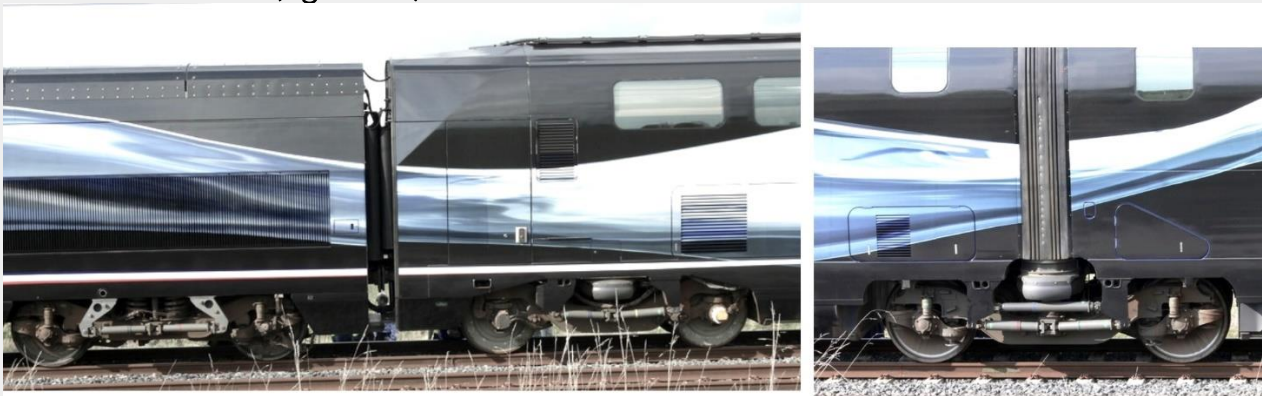
Amortisseurs anti-lacet du bogie moteur et du premier bogie porteur
