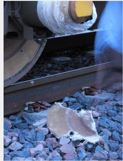
Figure 39 : Flasque disposé sur une roue instrumentée pour protéger les capteurs. Et morceau de flasque détruit. La dénomination technique étant devenue : « frisbees » ...
