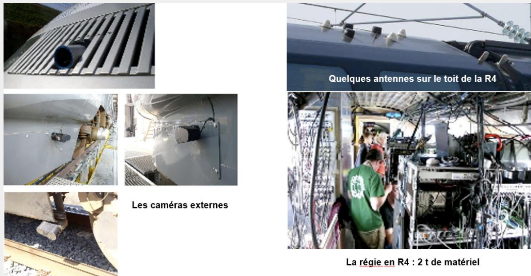
Figure 43 : A bord de la rame l'ensemble du dispositif nécessaire à la Com. Les caméras, la régie à bord, les antennes sur le toit de la R4
