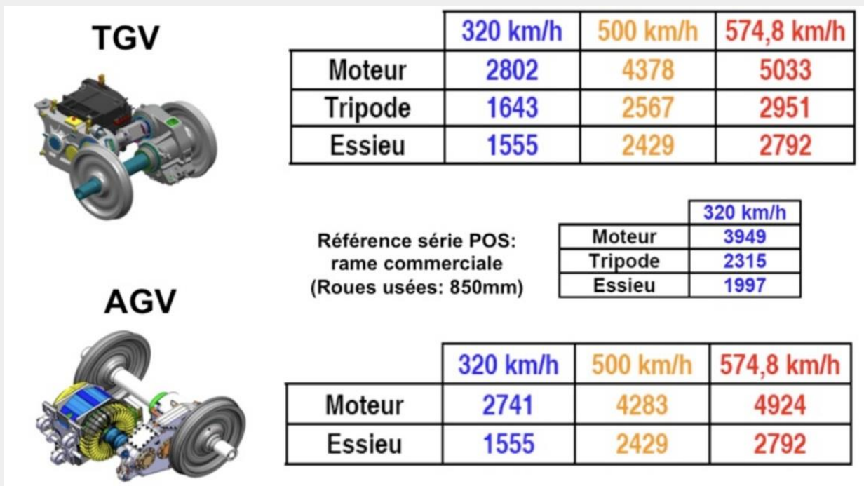
Figure 19 : Bilan comparé des vitesses de rotation des essieux et des moteurs pour un diamètre de roue de 1092 mm à différentes vitesses de circulation.
