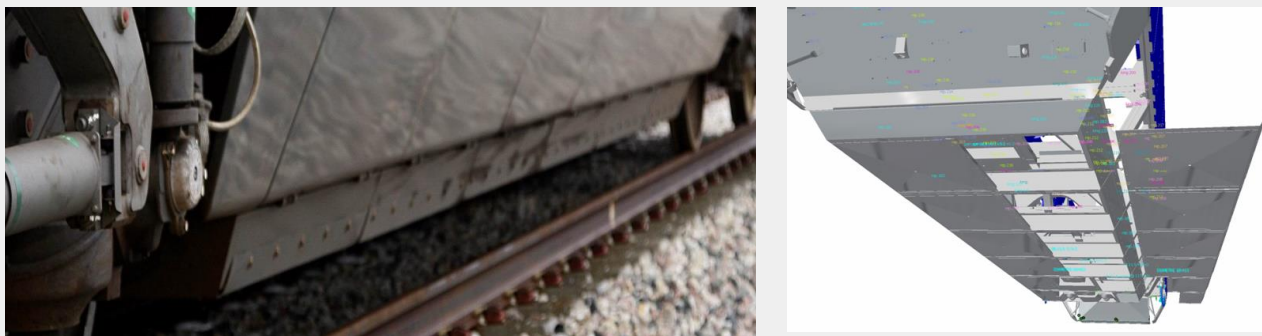
Figure 11 : Réduction de la garde au sol : installation d'un caisson sous les motrices M1 et M2
