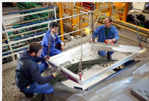
Figure 10 : Pose du vitrage affleurant. A comparer avec le vitrage et le revers d'eau des motrices duplex
