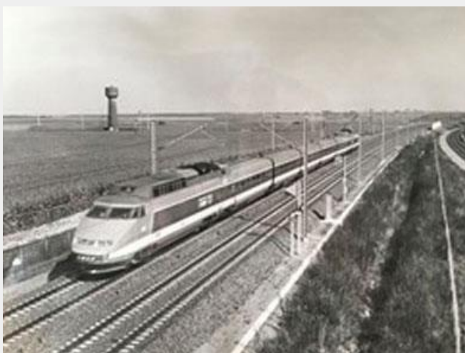
Figure 1 : Rame 88 : préfigure la motorisation des rames TGV Atlantique. Elle assure les premières montées en vitesse sur la LGVA. Photo Jean-Paul DEMOY
