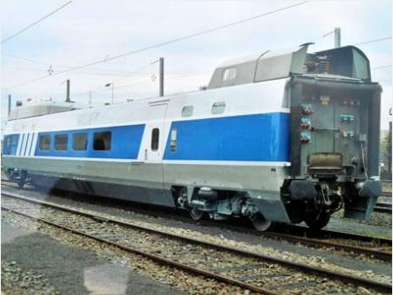
Figure 12 : Mélusine, voiture de mesure.
