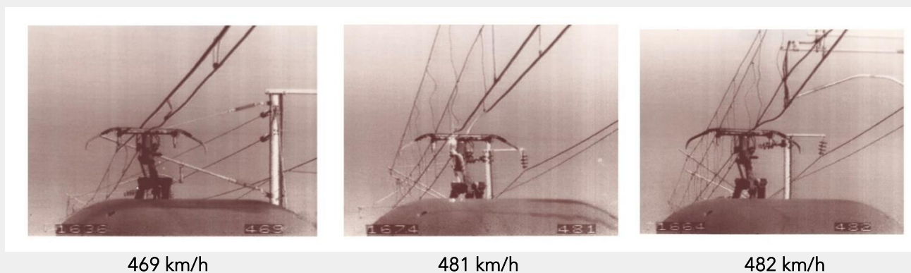
Figure 16 : Comportement critique du couple « pantographe-caténaire ». Images SNCF
